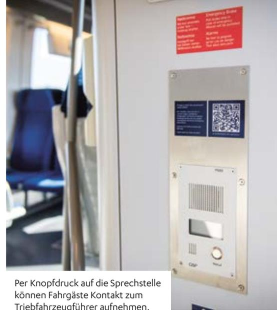
Per Knopfdruck auf die Sprechstelle können Fahrgäste Kontakt zum Triebfahrzeugführer aufnehmen.
