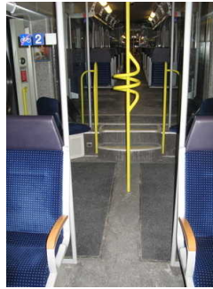
Treppe zwischen Niederflur- und Hochflurbereichen
