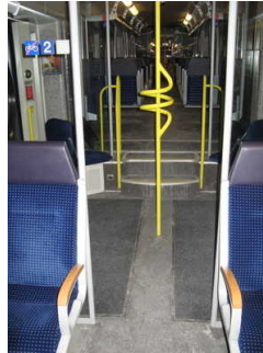
Treppe zwischen Niederflur- und Hochflurbereichen
